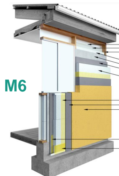
M6 Aislación térmica exterior en tabique de madera EIFS o listoneado de madera exterior
