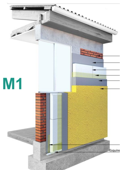
M1 Aislación térmica exterior en muro sólido EIFS o listoneado de madera exterior
