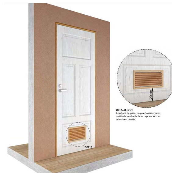
Celosías de paso de aire en puertas o muros interiores
