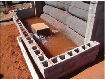
Objetivo: avaliar as consequências do colapso do solo de fundação no comportamento dos muros
