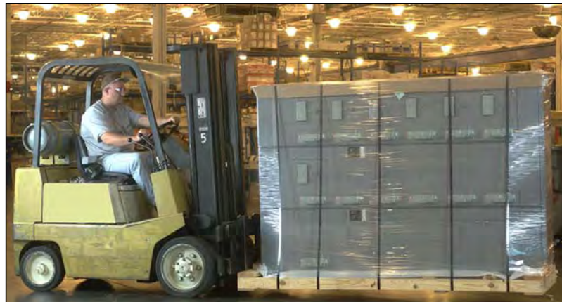
Figura 4 – Desplazamiento de los CCM con un montacargas
