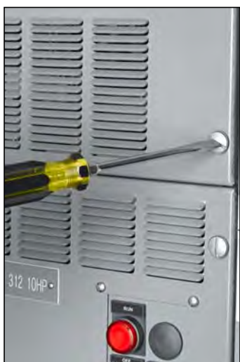
Figure 90 – Desserrage des fermetures imperdables
