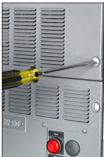
Figura 90 – Aflojando los sujetadores cautivos
