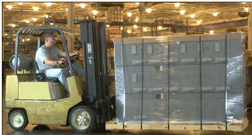
Figure 4 – Déplacement des CCM avec un chariot élévateur
