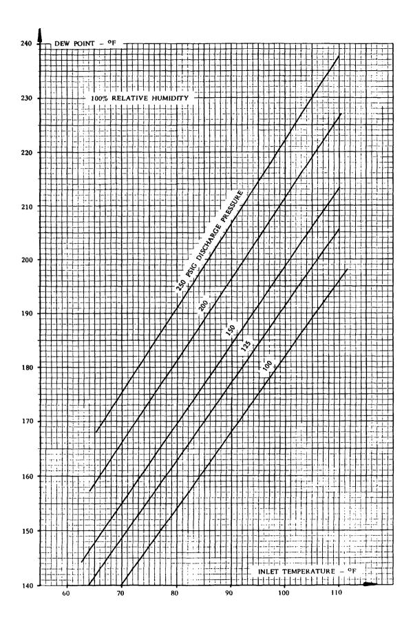
FIGURE 1-3 - RECOMMENDED DISCHARGE TEMPERATURE TO AVOID CONDENSATION
